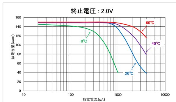
\* 標準容量は20°C環境において標準放電電流で放電した時、終止電圧2.0Vまでの持続時間から求めたものです。
